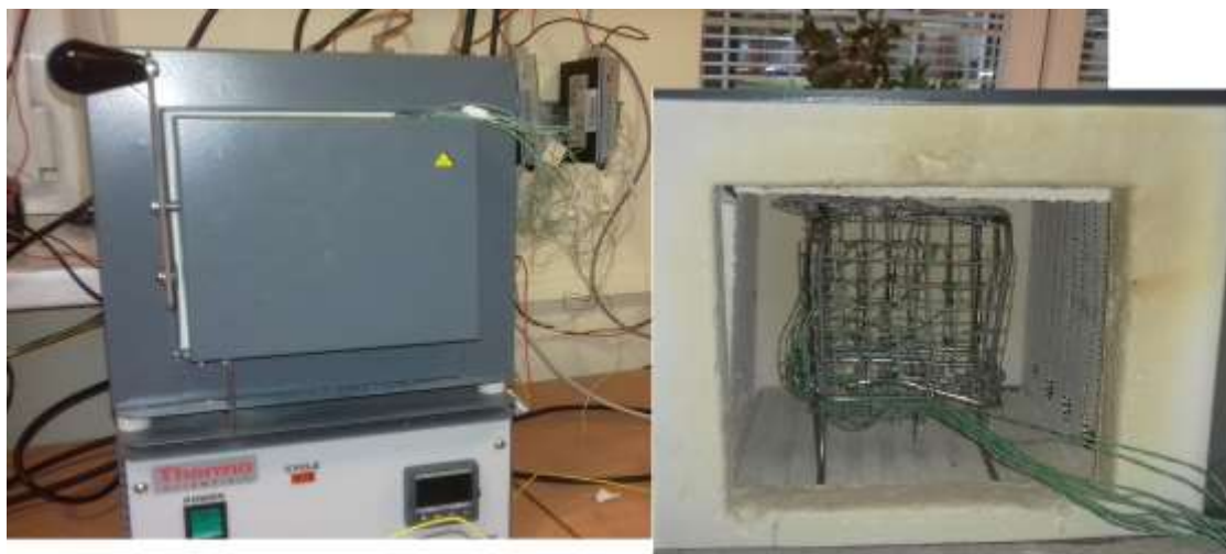
Rys. 10. Widok stanowiska laboratoryjnego: a) piec laboratoryjny, b) wnętrze pieca z termoelementami na rusztowaniu
