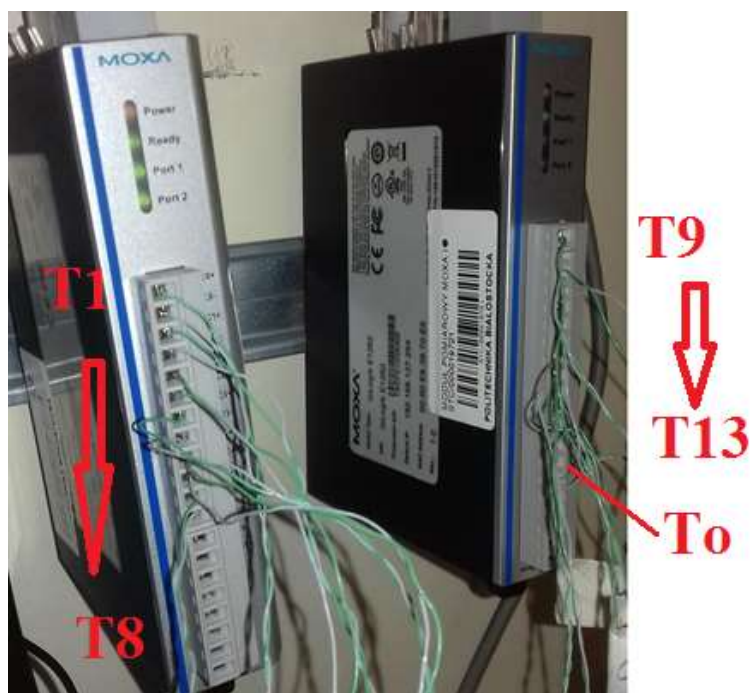
Rys. 12. Podłączenie termoelementów do modułów Moxa E1262
