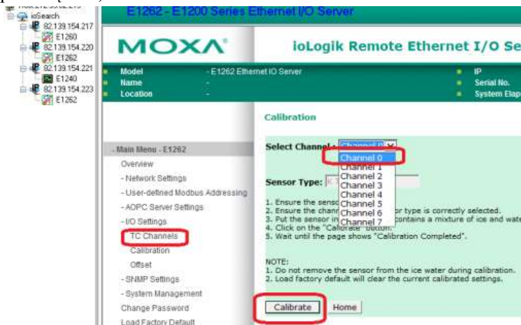
Rys. 17. Kalibracja poszczególnych kanałów modułu E 1262 o IP 82 139 154 220
