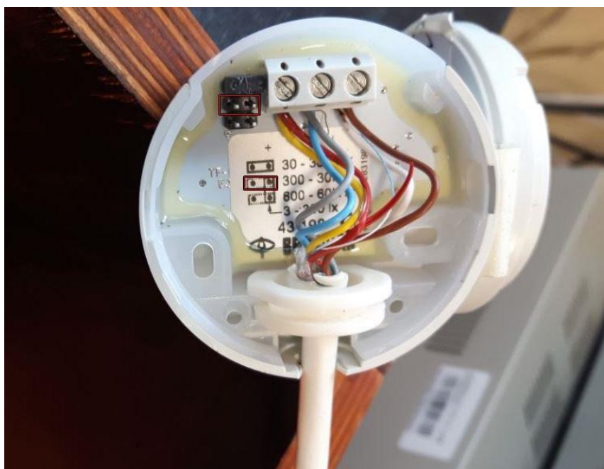
Rys. 4. Ustawienie zakresu czujnika 300 \div 30000lx
