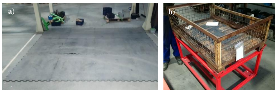
Rys. 2. Przykład zastosowania a) maty, b) wózka w celu poprawy ergonomii pracy
