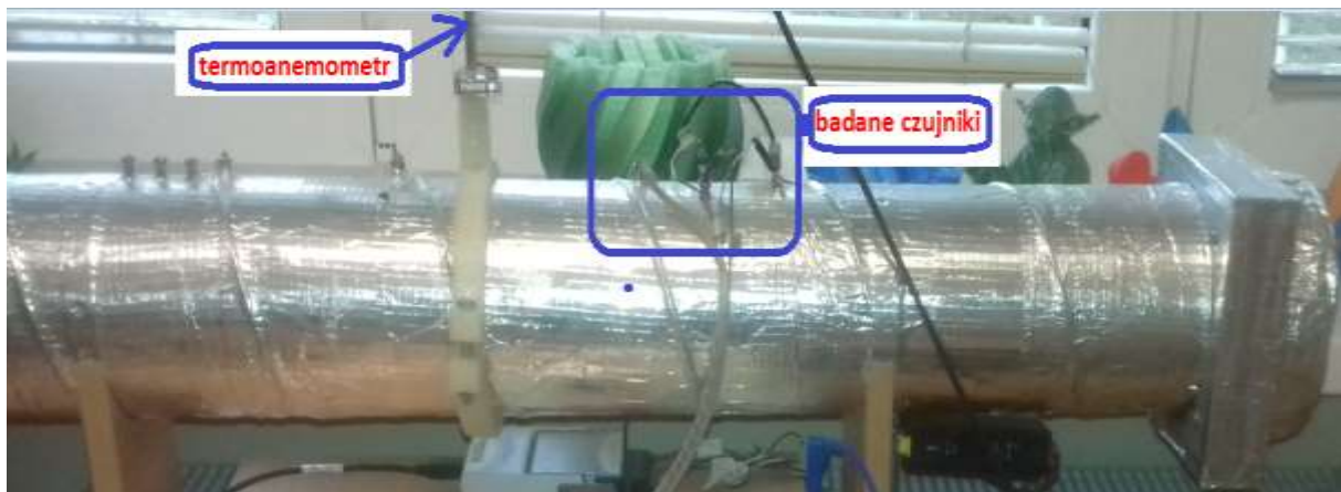
Rys.8. Miejsce zamocowania badanych termorezystorów i termoanemometru.
