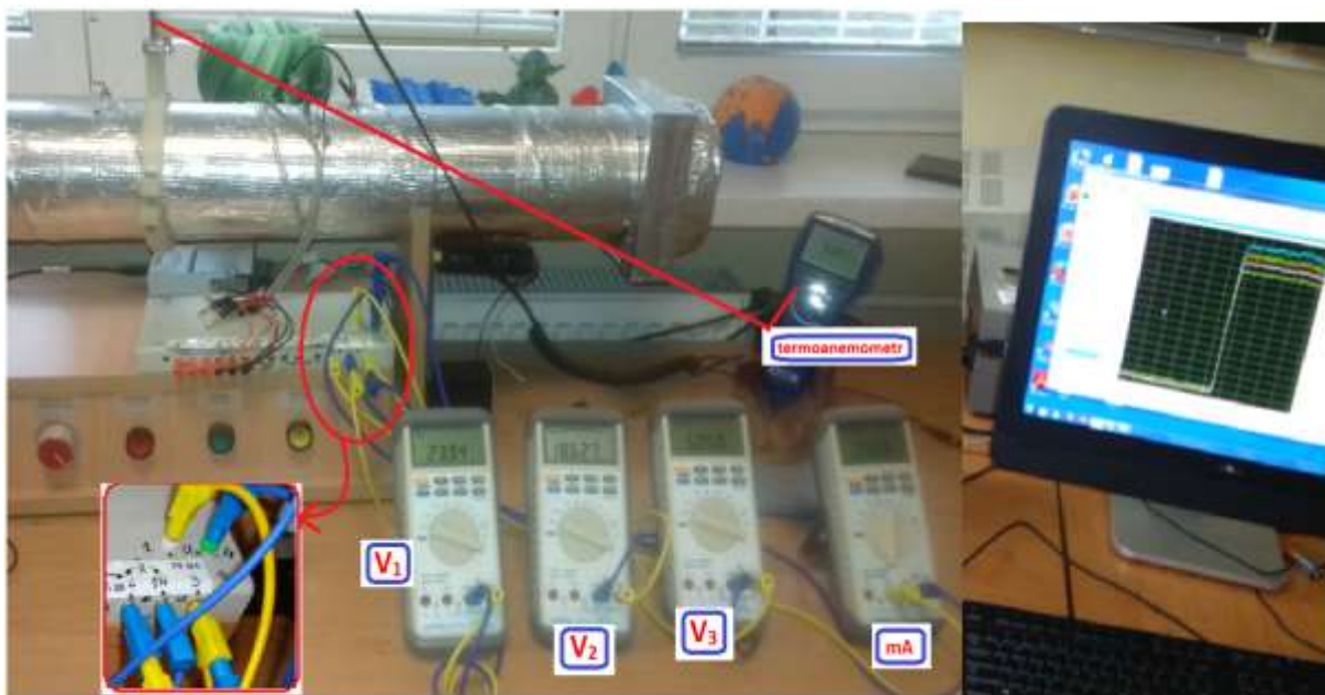
Rys.7. Widok stanowiska pomiarowego: 1, 1A, 2, 3, 4 – miejsca podłączeń mierników (zgodnie z rys. 6), V_1 , V_2 i V_3 – woltomierze do pomiaru napięć: zasilania, na termorezystorze i rezystorze wzorcowym, mA- miliamperomierz o zakresie do 20mA, termooanemometr VelociCalc 9515 - do pomiaru prędkości przepływu powietrza w rurze wentylacyjnej.
