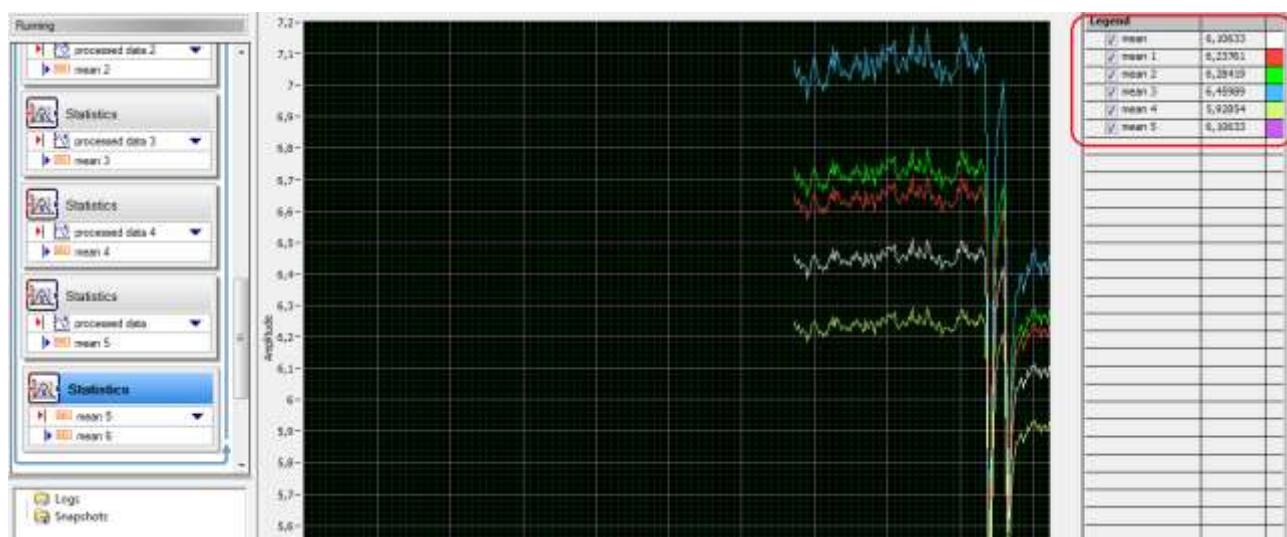
Rys. 26. Wizualizacja uśrednionych wartości prędkości przepływu powietrza (uzyskanych dla różnych postaci linii trendu aproksymującej charakterystykę termoanemometru).
