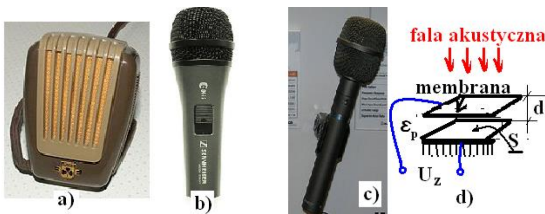
Rys. 2. Mikrofony: a) węglowy; b) dynamiczny; c) pojemnościowy; d) budowa mikrofonu pojemnościowego.
