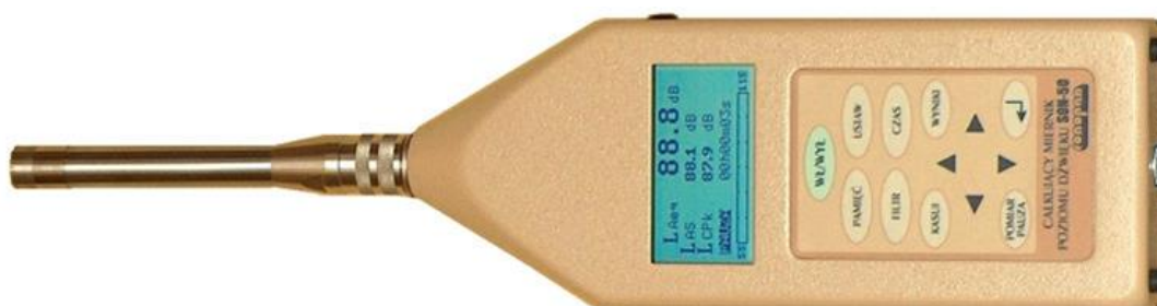
Rys. 5. Całkujący miernik poziomu dźwięku SON-50 - widok ogólny [7].
